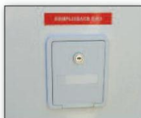
Trappe de remplissage d'eau.
