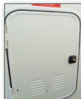
Compartiment gaz ventilé.
