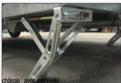
4 vérins stabilisateurs renforcés. boulonnés au
