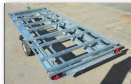
Châssis mécano-soudé galvanisé à chaud.
